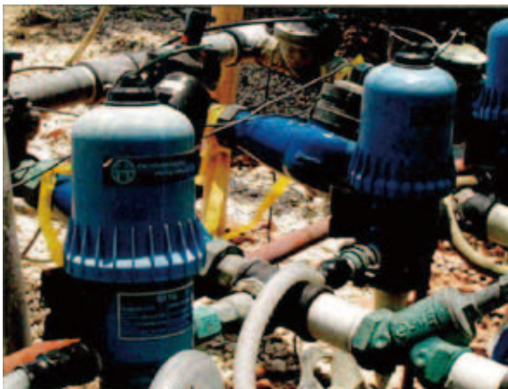
写真 5.11. ピストン式注入ポンプ (ドサトロン社)
