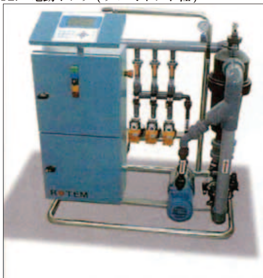
写真 5.13. 単肥混合システム (ローテム社)
