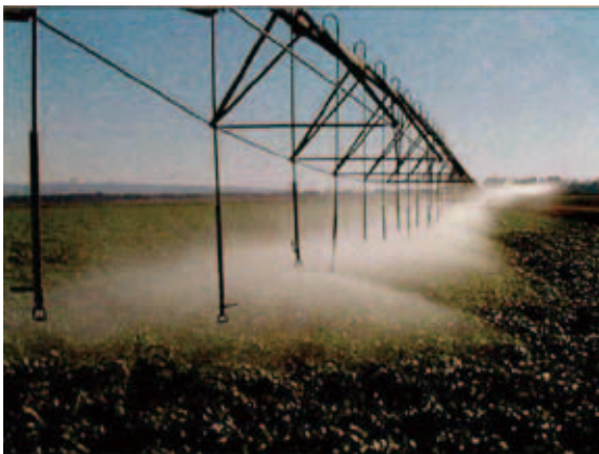
写真 5.7. リニアムーブによる機械化灌漑
